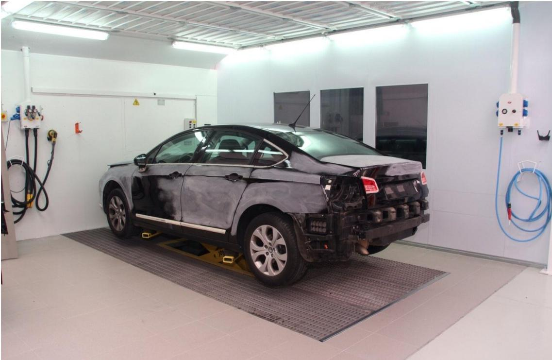
**BOX DE PINTURA CMC**, dotado de una lavadora de pistolas **ROSAUTO** mod. 165 (mixta agua y disolvente), mesa de trabajo serie INOX con ordenador integrado mural y máquina de mezclas.
