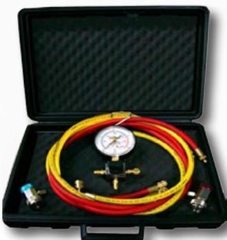
Este kit permite efectuar **PRUEBAS DE PERDIDAS con NITROGENO** en condiciones de presión en la instalación A/C.
