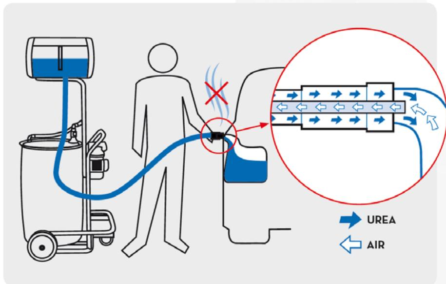
El Dispensador de AdBlue no puede ser contaminado, de ningún modo por agentes exteriores, gracias al innovador sistema de abastecimiento. El aire presente en el depósito del automóvil es desplazado al depósito superior durante el suministro al automóvil.
