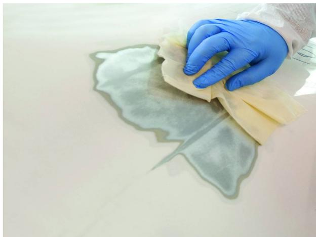
Las toallitas Bonderite 1455 sustituyen eficazmente a cualquier otro método más complejo y lento. Se pueden utilizar en aluminio, acero laminado en frío y en caliente, zinc o aleaciones de zinc y superficies galvanizadas. Esta revolucionaria innovación de Henkel se ha desarrollado a partir de un producto de pretratamiento de metales de enorme éxito, empleado normalmente para evitar la corrosión a largo plazo en todo tipo de uniones estructurales metálicas.
