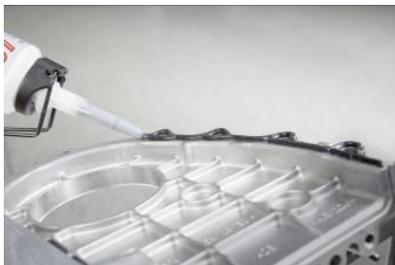
Las siliconas para sellado en automoción de Loctite pueden utilizarse para sellar una amplia variedad de los componentes del vehículo.
